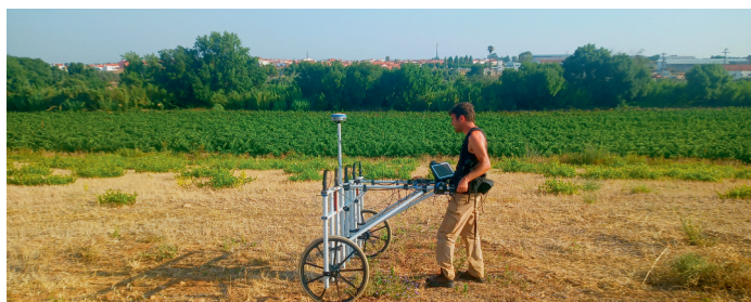
- Aplicação de Prospecção Geofísica por Magnetómetro pela Era-Arqueologia
