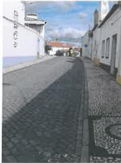
A faixa de rodagem atual é calçada regular 10x20cm. A faixa de rodagem passa toda a calçada de cubos de granito de 11x11cm. Nos passeios será utilizada a calçada miúda de granito 5x5cm com espelho de 0,03m, assinalando-se e demarcando-se através da textura e imagem as duas áreas de tráfego distintas. Nas transições serão aplicados lancis/guias de 0,10x1,00x0,20m.
