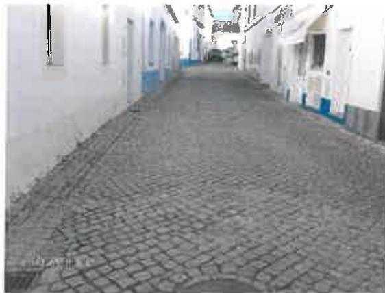
O pavimento existente é de cubos regulares que serão levantados e repostos, com reperfilamento dos passeios e criação de bolsas de estacionamento. A faixa de rodagem será toda em cubos de granito 11x11 aplicados de forma diagonal e as bolsas de estacionamento de material
