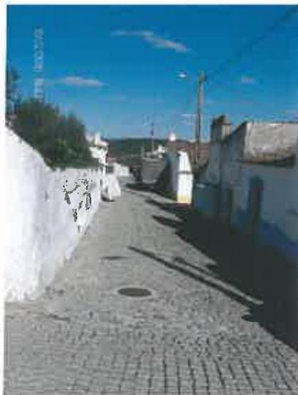
O pavimento existente é calçada irregular de basalto. A faixa de rodagem passa toda a calçada de cubos de granito de 11x11cm. A área de estacionamento será idêntica, mas aplicada na posição ortogonal. Nos passeios será utilizada a calçada miúda de granito 5x5cm com espelho de 0,03m, assinalando-se e demarcando-se através da textura e imagem as duas áreas de tráfego distintas. Nas transições serão aplicados lancis/guias de 0,10x1,00x0,20m.
