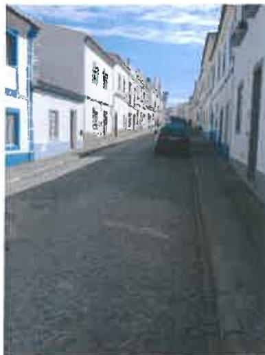
O pavimento existente é de cubos regulares que serão levantados e repostos, com reperfilamento dos passeios e criação de bolsas de estacionamento. A faixa de rodagem será toda em cubos de granito 11x11 aplicados de forma diagonal e as bolsas de estacionamento de material idêntico mas colocado de forma ortogonal. A faixa de rodagem passa toda a calçada de cubos de granito de 11x11cm. A área de estacionamento será
