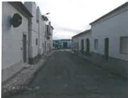
A faixa de rodagem atual é de asfalto betuminoso que será removido. A faixa de rodagem passa toda a calçada de cubos de granito de 11x11cm. Nos passeios será utilizada a calçada miúda de granito 5x5cm com espelho de 0,03m, assinalando-se e demarcando-se através da textura e imagem as duas áreas de tráfego distintas. Nas transições serão aplicados lancis/guias de 0,10x1,00x0,20m.
