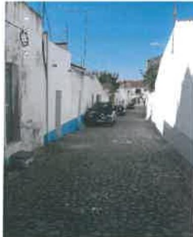
O pavimento existente é calçada irregular de basalto. A faixa de rodagem passa toda a calçada de cubos de granito de 11x11cm. Nos passeios será utilizada a calçada miúda de granito 5x5cm com espelho de 0,03m, assinalando-se e demarcando-se através da textura e imagem as duas áreas de tráfego distintas. Nas transições serão aplicados lancis/guias de 0,10x1,00x0,20m.
