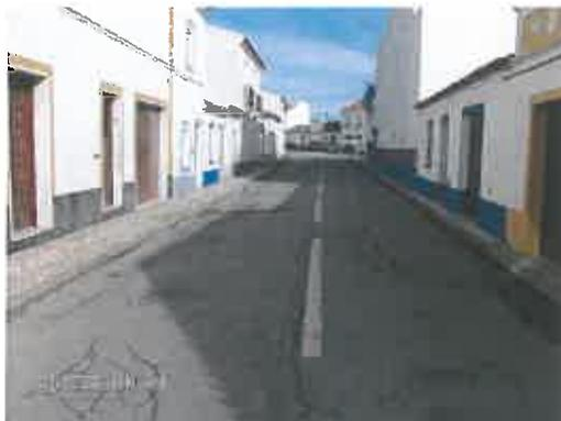
A faixa de rodagem atual é de asfalto betuminoso que será removido. A faixa de rodagem passa toda a calçada de cubos de granito de 11x11cm. Nos passeios será utilizada a calçada miúda de granito 5x5cm com espelho de 0,03m, assinalando-se e demarcando-se através da textura e imagem as duas áreas de tráfego distintas. Nas transições serão aplicados lancis/guias de 0,10x1,00x0,20m.
