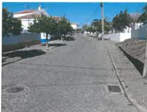
O pavimento existente é de cubos regulares que serão levantados e repostos, com reperfilamento dos passeios e criação de bolsas de estacionamento. A faixa de rodagem será toda em cubos de granito 11x11
