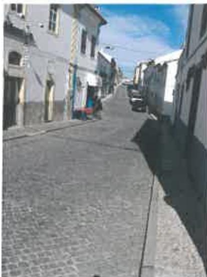
A faixa de rodagem atual é calçada regular 10x20cm. A faixa de rodagem passa toda a calçada de cubos de granito de 11x11cm. A área das bolsas de estacionamento será idêntica, mas aplicada na posição ortogonal. Nos passeios será utilizada a calçada miúda de granito 5x5cm com espelho de 0,03m, assinalando-se e demarcando-se através da textura e imagem as duas áreas de tráfego distintas. Nas transições serão aplicados lancis/guias de 0,10x1,00x0,20m.
